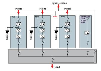
работоспособность остальных блоков и надежность всей установки в целом. В связи с этим, автоматическое переключение на байпас происходит только в том случае, когда имеют место серьезные неисправности инверторов или при наличии форс-мажорной ситуации вне установки - например, короткое замыкание на выходе.
